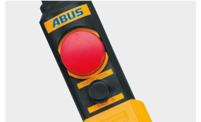
alternativ: Hubgrenzschalter mit 2 zusätzlichen Zwischenpositionen. Erweiterung des elektronischen Hubgrenzschalters um 2 zusätzliche programmierbare Abschaltpunkte, zwischen der oberen und unteren Abschaltposition. Diese können als „Stop-and-Go-Positionen“ angefahren und anschließend auch überfahren werden.
