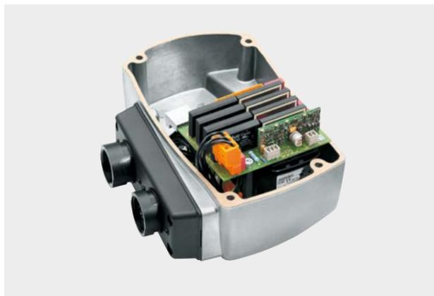
alternativ: Halbleitersteuerung für Heben / Senken und Katzfahren. Erweiterte Elektroniksteuerung in Halbleitertechnologie für die Funktion elektrisch Katzfahren. Bei der Baugröße GM2 ist die Steuerung in einem am Kettenzug angebrachten Zusatzgehäuse integriert.
