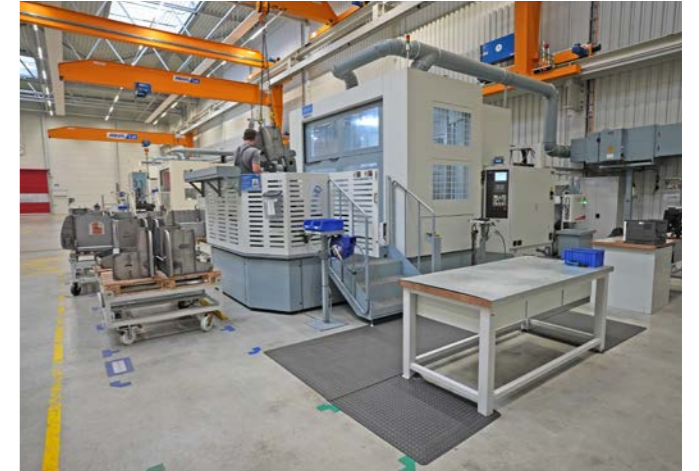
Mechanische Bearbeitung des Seilzug-Gehäuse auf 4-Achsen Fräszentren
